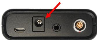
Das Instrument steht nicht in Betrieb, während die Akkus aufgeladen werden.
