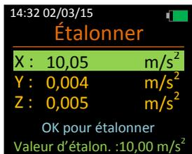
Fixez l'accéléromètre au calibrateur pour que les vibrations passent par l'axe de votre choix.
