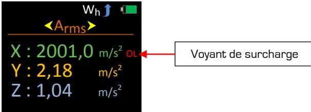
Le voyant de surcharge reste allumé pendant au moins 2 secondes ou pendant que la condition de surcharge reste, mais dans l'état d'arrêt ou l'état d'enregistrement, le voyant de surcharge est verrouillé sur les écrans suivants :
