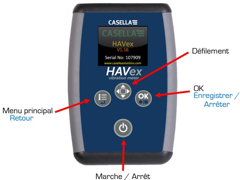
Figure 2 - Disposition du clavier
