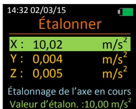
Si l'étalonnage est réussi, « Axe étalonné » s'affiche en jaune pendant 5 secondes, ou si l'étalonnage échoue, « Échec de l'étalonnage » s'affiche en rouge pendant 5 secondes.
