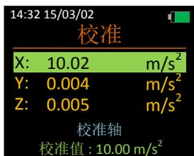
如果校准成功完成，则将以黄色显示已校准的轴 5 秒钟；如果校准失败，则将以红色显示已失败的校准 5 秒钟。
