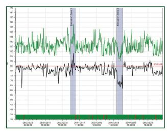
Zeitbilanzprofile von Daten wie Durchschnitts- (1 s und 1 min.), Maximal- und Spitzenwerten ermöglichen eine Identifikation von Problemquellen (mit Unterstützung der Funktion zur Audioerfassung der Versionen dBadge2 Plus & Pro). Ausschlusszonen ermöglichen Berechnungen im Sinne von "Was wäre wenn?" zur Bewertung des potenziellen Einflusses von Schallschutzmaßnahmen. Der Bewegungsindex bestätigt die Nutzung von dBadge2 zur Bestätigung der Validität einer oft unbeaufsichtigten Messung.
