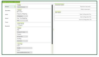
dBadge2 ermöglicht eine gleichzeitige Messung zahlreicher Parameter bei individueller Auswahl von Anzeigen an bis zu 3 virtuellen Dosimetern über Konfigurationsfunktionen. Inbegriffen sind weitere Funktionen wie Bluetooth-Konnektivität, Pause, Alarmausgabe und Timer. Außerdem ist die Auswahl einer Oktavbandanalyse möglich (nur Version dBadge2 Pro) zur allgemeinen Anzeige der Schallumgebung zur Unterstützung bei der Auswahl von Gehörschutz oder anderen Schallschutzmaßnahmen.
