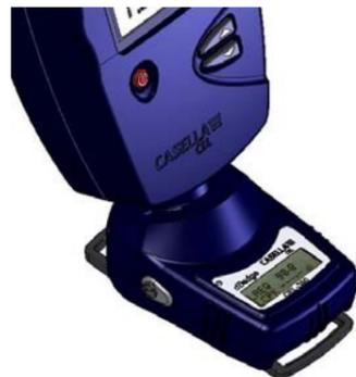
Allumez l'étalonneur CEL-110. Le *d*Badge reconnaîtra automatiquement qu'une tonalité de calibrage est présente et se mettra en mode de calibrage, avec l'écran ci-dessous.
