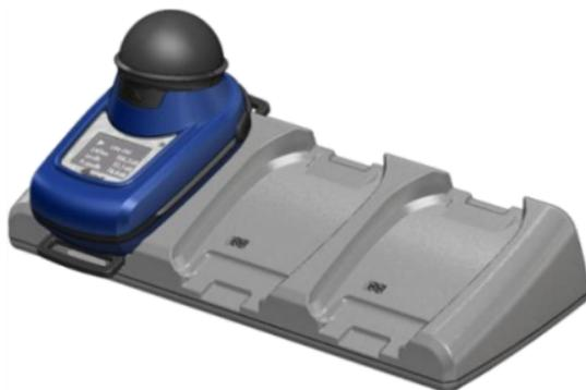
dBadge2 отображает статус зарядки и гаснет через приблизительно 20 секунд; LED индикатор состояния во время зарядки периодически мигает красным цветом и загорается синим цветом, когда дозиметр полностью заряжен. Чтобы активировать дисплей во время зарядки, нажать любую кнопку или наклонить стыковочную станцию вперед.
