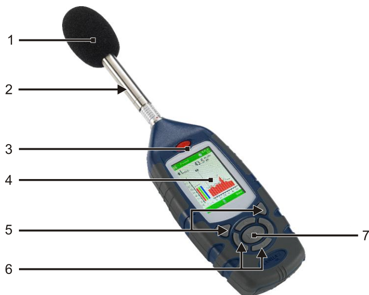
Figura 1. Características principales del sonómetro CEL-63x
