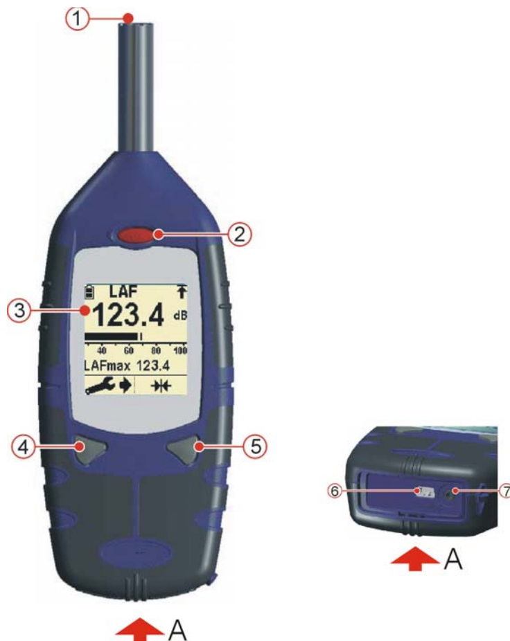
Figura 1: Decibelímetro Digital CEL-24X
