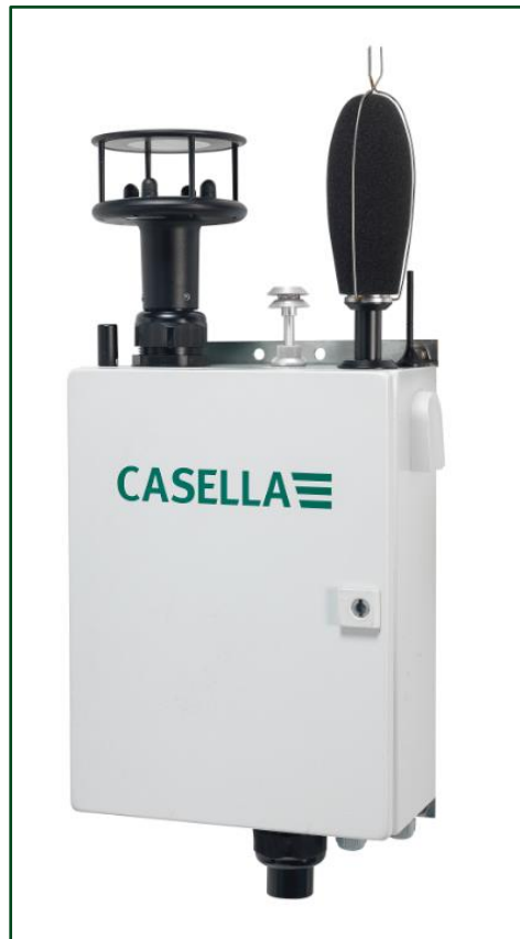
Système Guardian2 avec capteurs de particules, de bruit et de vent
