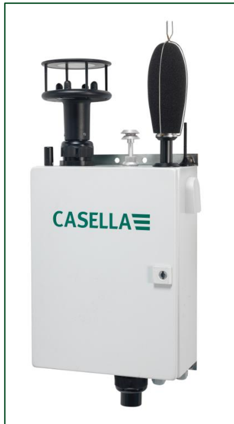
Sistema Guardian2 con sensores de partículas, ruido y viento
