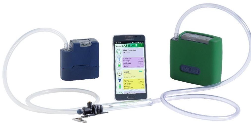
VAPex nella taratura a circuito chiuso
