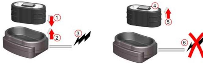
Abbildung 3 Einlegen der Batterie in das Ladegerät
