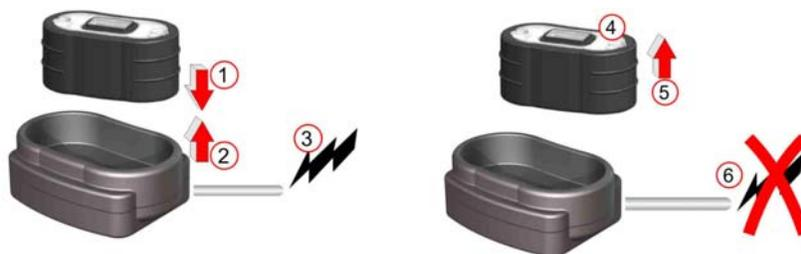
Figura 3 Colocação da Bateria no Carregador
