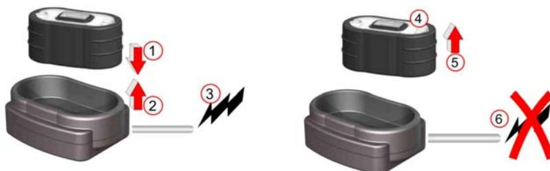
Figura 3 Inserire la batteria nel caricatore
