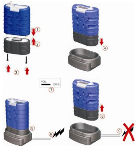
Legen Sie die Batterie ein und schließen Sie das Ladegerät an
