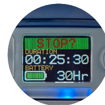
Visor codificado por cores que mostra a duração restante da bateria
